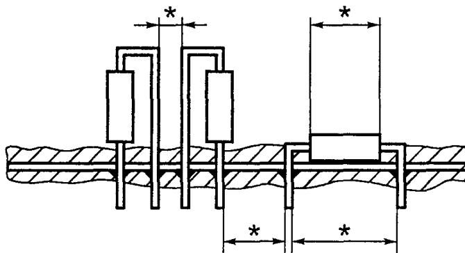
Выходы резистора не герметизированы в пределах покрытия, поэтому для всех размеров, отмеченных знаком \*, применимы требования 6.4.3 и 6.4.7
