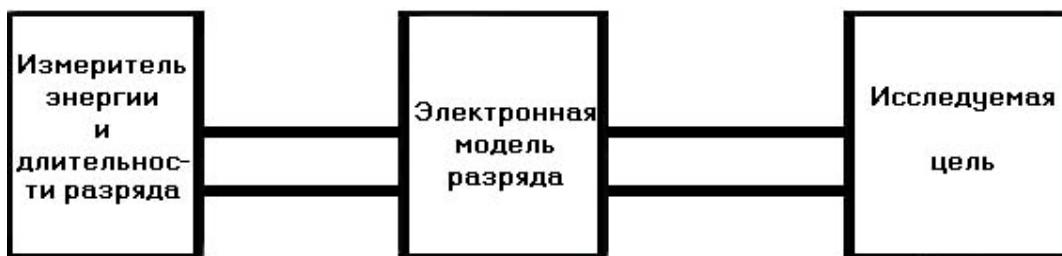
Рисунок А.26. Блок схема установки для электроизмерительной оценки параметров разряда
