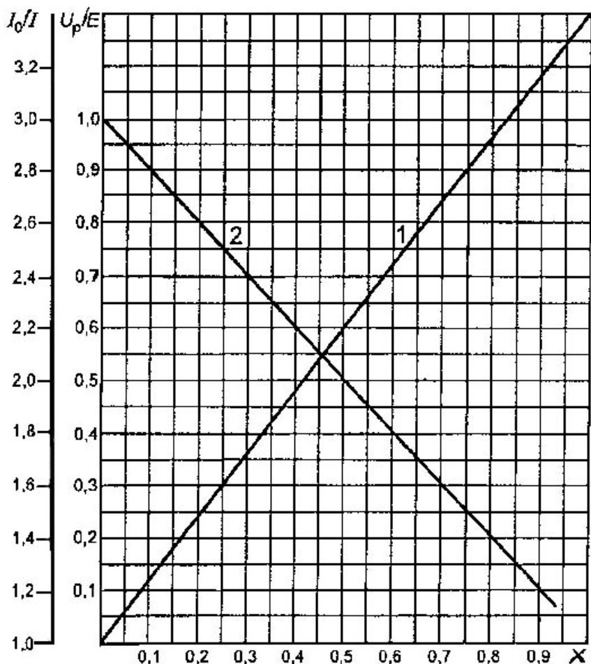
Рисунок A1.4. Зависимости кратности токов (1) и напряжений (2) от параметра  $X=(K-I)/K(I-B)$
