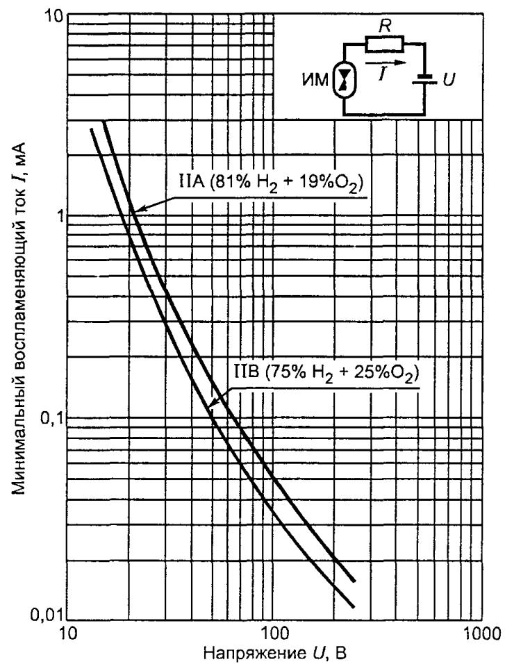
*Рисунок A.11. Минимальный воспламеняющий ток в активизированных взрывоопасных водородно-кислородных смесях для омических цепей*
