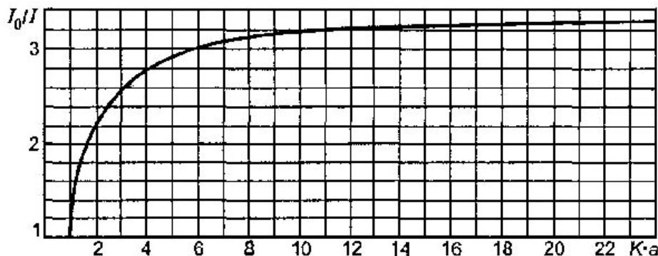
Рисунок A1.2. Зависимость кратности токов от  $K$  и  $Ka$
