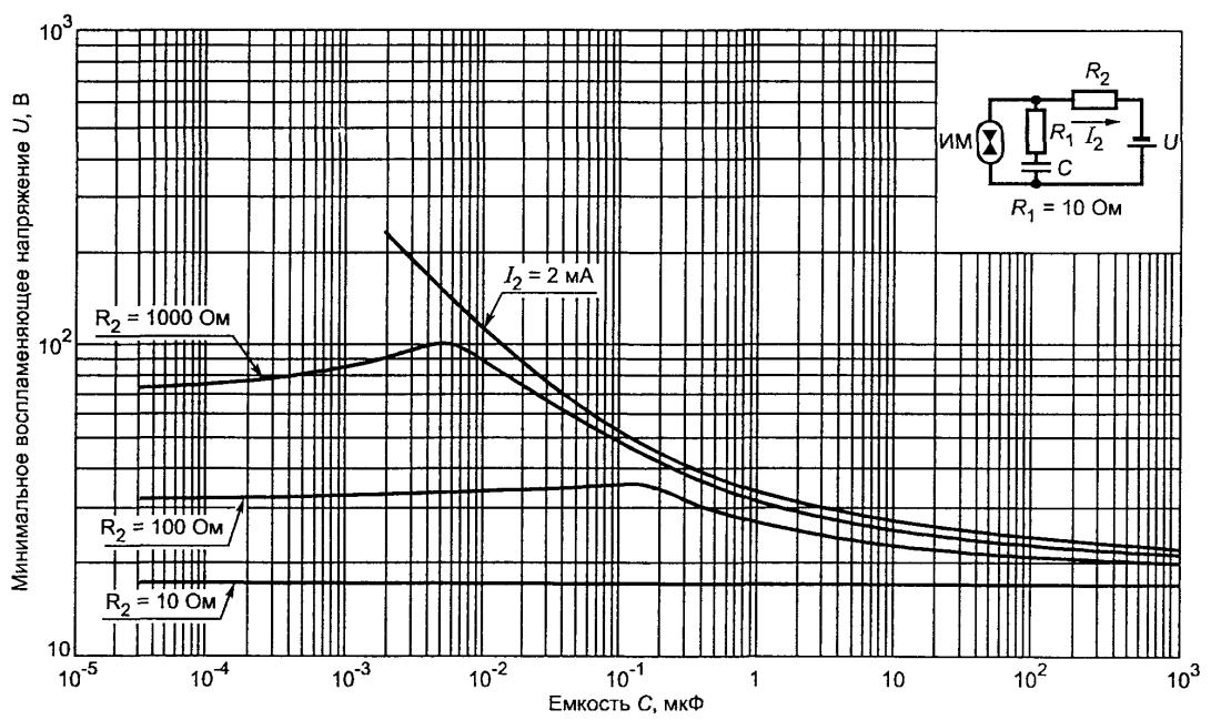
Рисунок A.13. Минимальное воспламеняющее напряжение в активизированной взрывоопасной водородно-кислородной смеси ( $81\% H_2 + 19\% O_2$ ) для емкостных цепей подгруппы IIА при  $R_1 = 10 \Omega$
