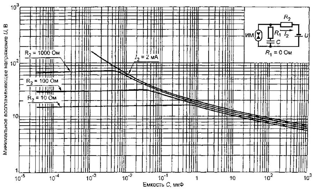
Рисунок A.16. Минимальное воспламеняющее напряжение в активизированной взрывоопасной водородно-кислородной смеси ( $75\% H_2 + 25\% O_2$ ) для емкостных цепей подгруппы II В при  $R_1 = 0 \Omega$
