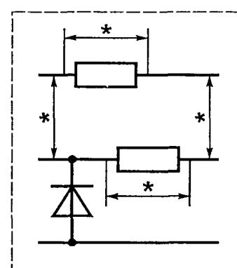
**г) Защита предохранителей в искробезопасной цепи**
