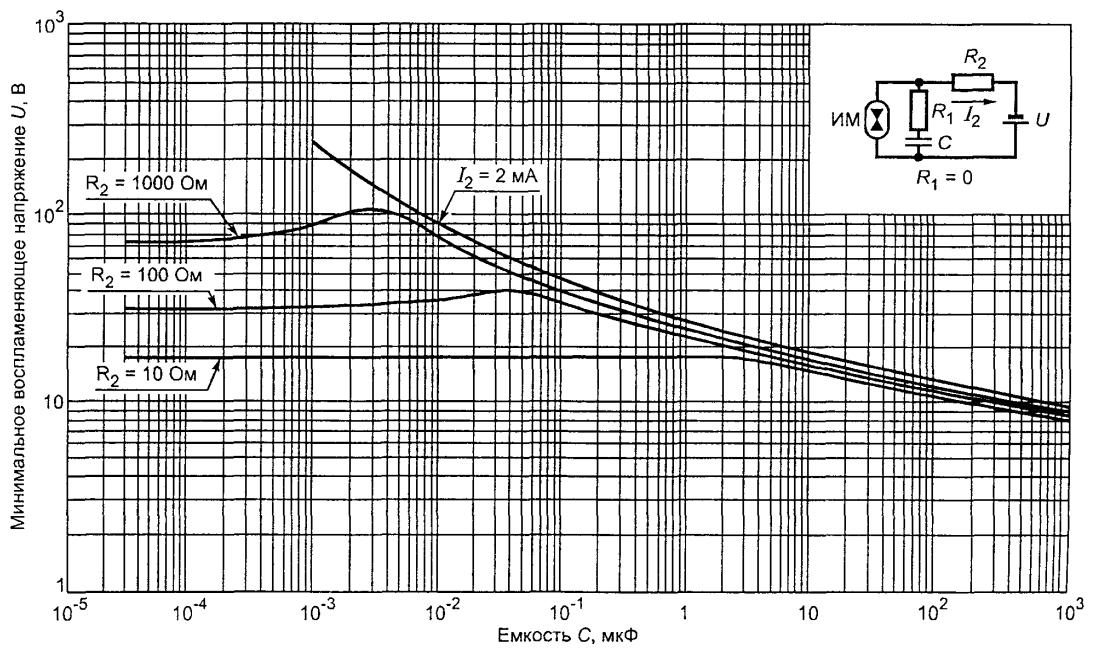
Рисунок A.12. Минимальное воспламеняющее напряжение в активизированной взрывоопасной водородно-кислородной смеси (81 %  $H_2$  + 19 %  $O_2$ ) для емкостных цепей подгруппы HA при  $R_1 = 0 \Omega$
