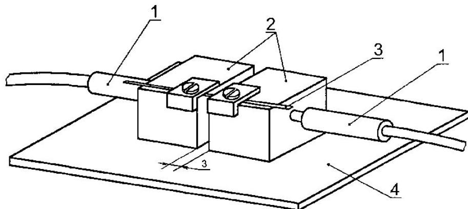
1 - подвод питания; 2 - медный бруск; 3 - вольфрамовая проволочка; 4 - изолирующая пластина
