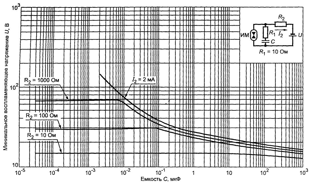
Рисунок A.17. Минимальное воспламеняющее напряжение в активизированной взрывоопасной водородно-кислородной смеси ( $75\% \text{H}_2 + 25\% \text{O}_2$ ) для емкостных цепей подгруппы IIВ при  $R_1 = 10 \Omega$
