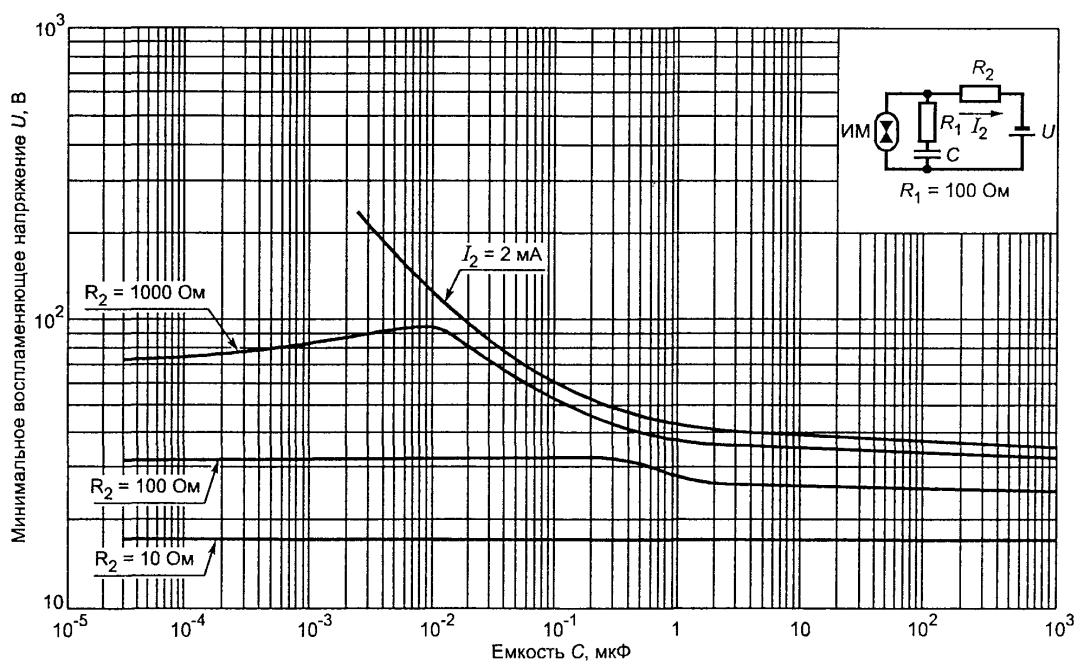
Рисунок A.14. Минимальное воспламеняющее напряжение в активизированной взрывоопасной водородно-кислородной смеси ( $81\% H_2 + 19\% O_2$ ) для емкостных цепей подгруппы PA при  $R_1 = 100 \Omega$
