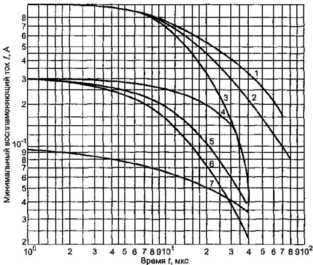
1-3 - индуктивность  $10^{-4}$  Гн, ЭДС источника 30, 45, 72 В соответственно; 4-6- индуктивность  $10^{-3}$  Гн, ЭДС источника 45, 72, 140 В соответственно, 7 - индуктивность  $10^{-2}$  Гн, ЭДС источника 72 В
