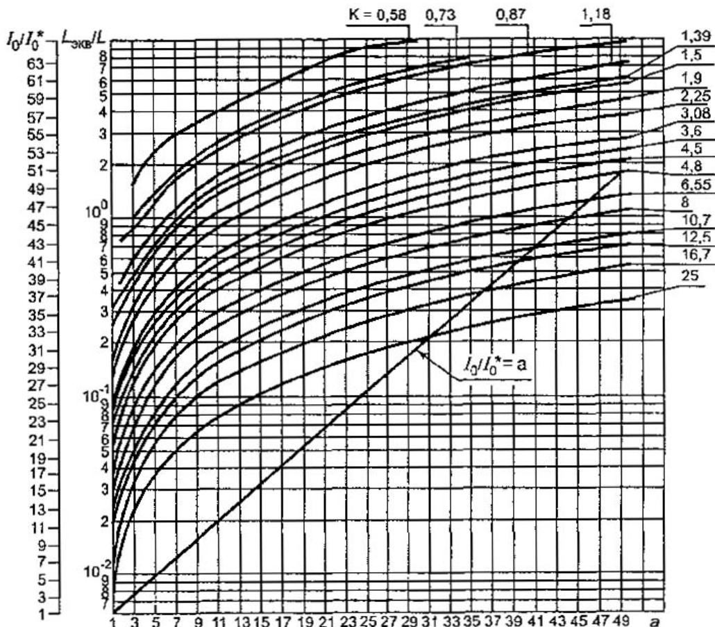
Рисунок A1.3. Зависимость кратностей индуктивностей и токов от значения коэффициента  $a$
