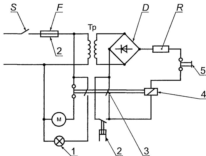
S - выключатель; F - предохранитель;  $T_p$  - трансформатор; D - диодный выпрямительный мост; R - резистор; M - приводной двигатель; 1 - сигнальная лампа; 2 - датчик давления; 3 - удерживающий контакт; 4 - реле; 5 - кнопка сброса
