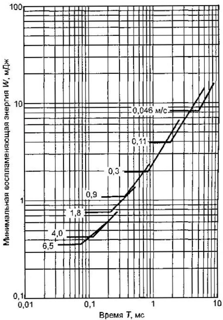
Рисунок А.20. Минимальная воспламеняющая энергия мета-новоздушной смеси (8,3 %  $CH_4$  + 91,7 % воздух) в зависимости от длительности разряда и скорости размыкания контактов цепи для группы I
