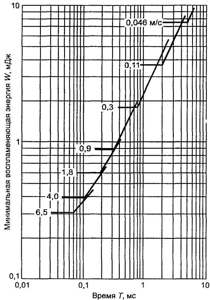
Рисунок A.21. Минимальная воспламеняющая энергия пропановоздушной смеси ( $5,3\% C_3H_8 + 94,7\%$  воздух) в зависимости от длительности разряда и скорости размыкания контактов цепи для подгруппы IIА
