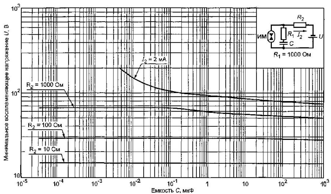
Рисунок А.19. Минимальное воспламеняющее напряжение в активизированной взрывоопасной водородно-кислородной смеси ( $75\% H_2 + 25\% O_2$ ) для емкостных цепей подгруппы IIВ при  $R_1 = 1000 \Omega$
