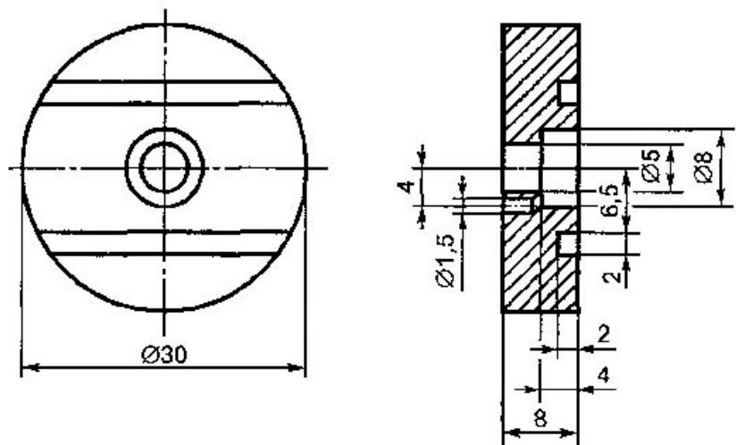
Рисунок Б.2. Кадмиеый контактный диск
