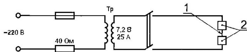
$T_p$  - трансформатор с площадью поперечного сечения сердечника  $19 \text{ см}^2$ ; 1 - вольфрамовая проволочка; 2 - медные бруски
