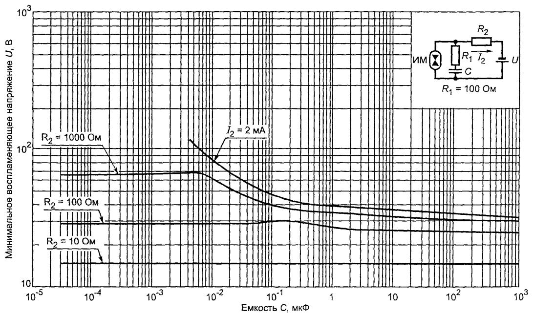
Рисунок A.18. Минимальное воспламеняющее напряжение в активизированной взрывоопасной водородно-кислородной смеси ( $75\% \text{H}_2 + 25\% \text{O}_2$ ) для емкостных цепей подгруппы ПВ при  $R_1 = 100 \Omega$
