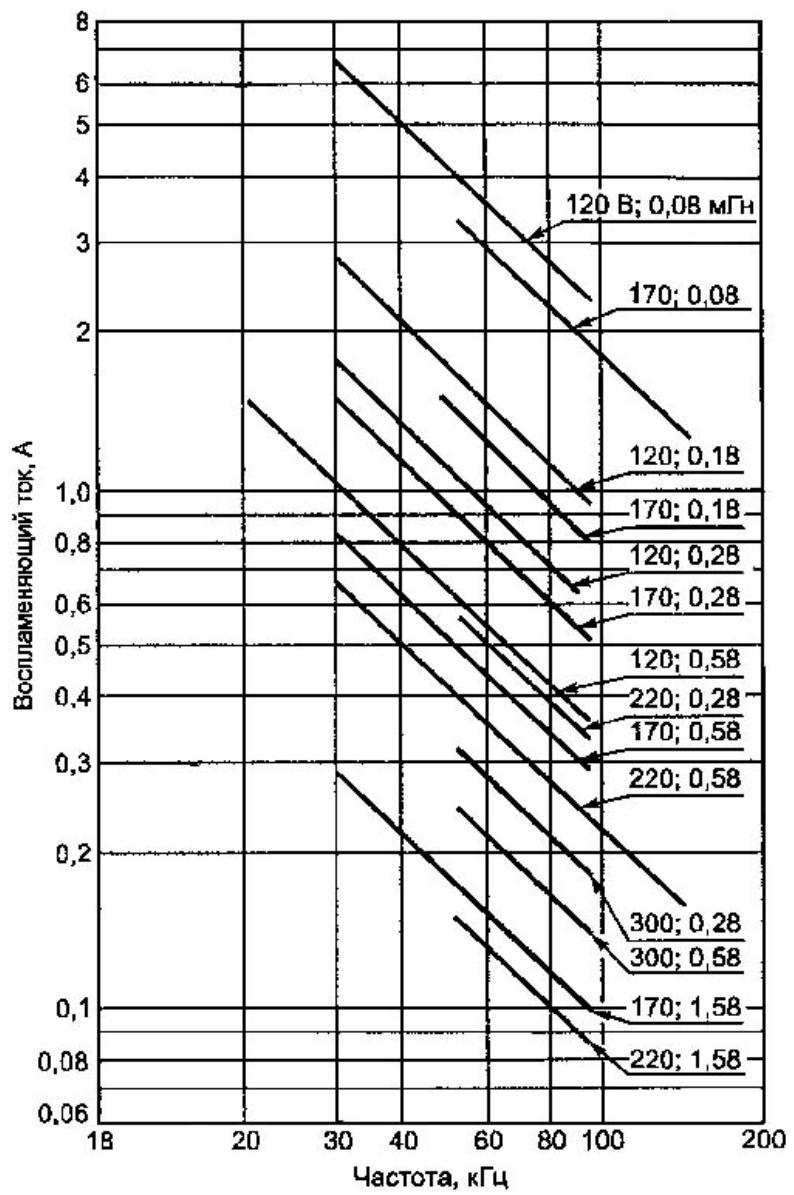
Рисунок A1.15. Зависимость воспламеняющего тока от частоты, индуктивности и напряжения источника для метановоздушной смеси
