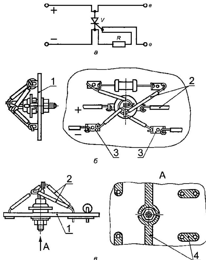
Рисунок B.2. Пример выполнения блока искрозащиты на тиристорах
