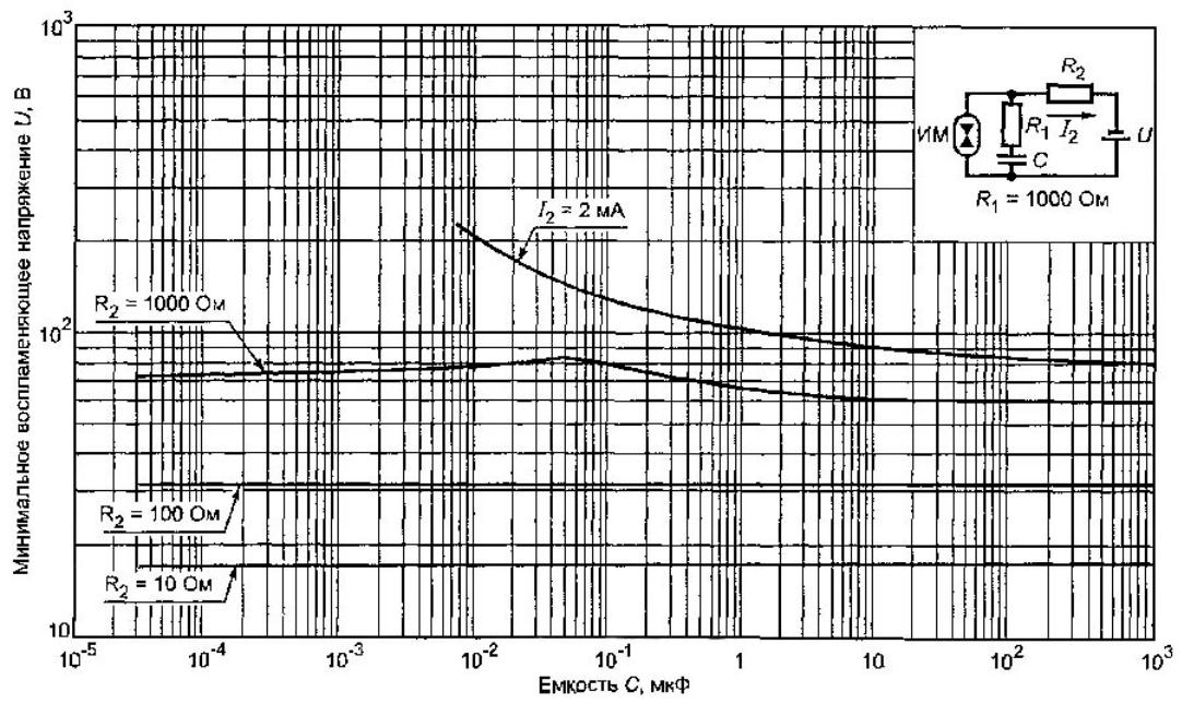
Рисунок А.15. Минимальное воспламеняющее напряжение в активизированной взрывоопасной водородно-кислородной смеси (81 %  $H_2$  + 19 %  $O_2$ ) для емкостных цепей подгруппы IIА при  $R_1 = 1000 \Omega$
