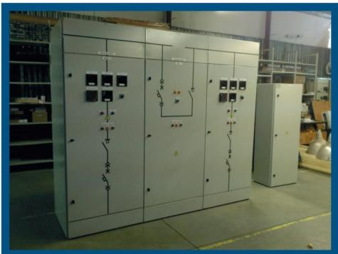
Щиты собственных нужд переменного тока серии ЩСН предназначены для приема и распределения электрической энергии переменного тока от силовых понижающих трансформаторов собственных нужд мощностью до 1000 кВА по потребителям. ЩСН позволяют управлять механизмами, электрическими агрегатами, устройствами управления и другими токоприемниками системы собственных нужд.
